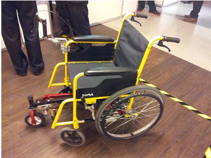
機械系陳沛仲老師與企管系楊雪蘭老師共同指導機械系高永發、吳宜靜，企管系翁浩耀、楊佳蓉、黃邈翔、洪瑋倫、莊立榮及產設系賴以寬同學，該團隊『力健 ER 股份有限公司』的產品"偏癱復健輪椅"獲得最佳人氣獎。該輪椅是由本團隊開發的外掛式偏癱復健模組結合手動輪椅而成，除了可輔助患者行動外，亦可達到腳部復健的功能。此外，轉向把手可依患者需求，安裝於輪椅的左側或右側。不使用時，可拆除部分模組，讓此復健輪椅仍可折疊收納，方便攜帶外出。
